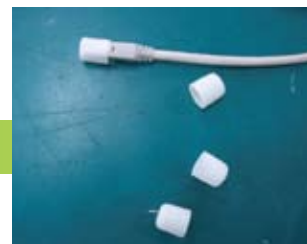
再利用するケーブルのキャップ
